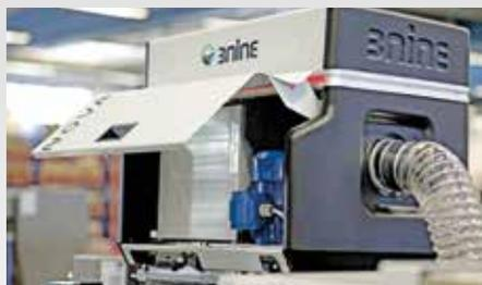
Riemenantriebs sowie des Motors kontrolliert. Der Zustand des Gerätes wird durch eine LED RGB-Anzeige auf der Vorder- und Rückseite der Nova sichtbar
