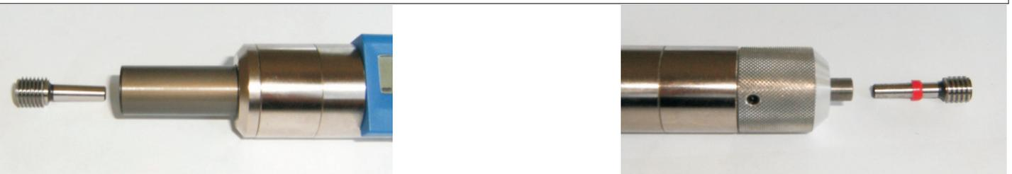
Der Gewindelehrdorn wird in den Konus des Dorns eingeführt, angedrückt und durch einen leichten Schlag mit einem Schonhammer befestigt .
