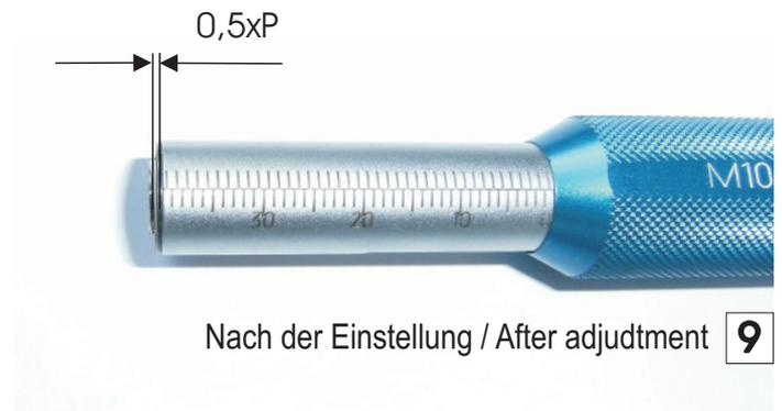
Nach dem Lösen der Gewindestifte (9) wird der Anfang des Gewindelehrdornes durch Drehen an dem Gewindeausschusslehrdorn (2) an die Stelle gesetzt , dass der Gewindegang des Lehdornes auf einer Linie mit der Plananlagefläche der Messhülse liegt .Dies wird mit einer Tiefenmessschraube überprüft.
